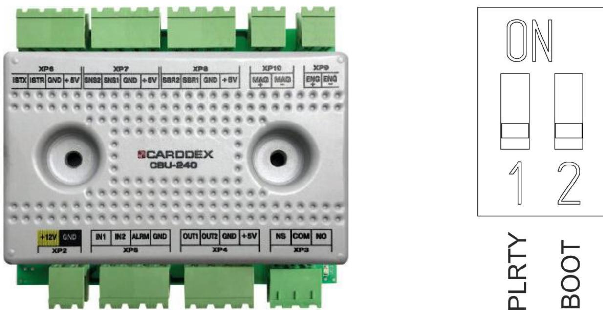
Рисунок 6.3.1 Контроллер управления турникетом «СВУ-240»
