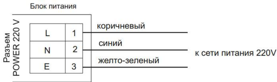
Рисунок 26. Схема подключения блока питания
