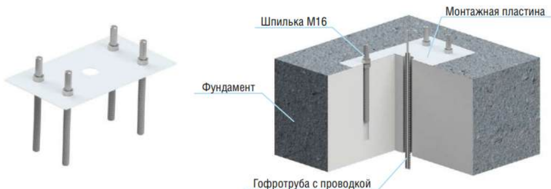
Рисунок 20. Устройство фундамента с монтажным комплектом.
