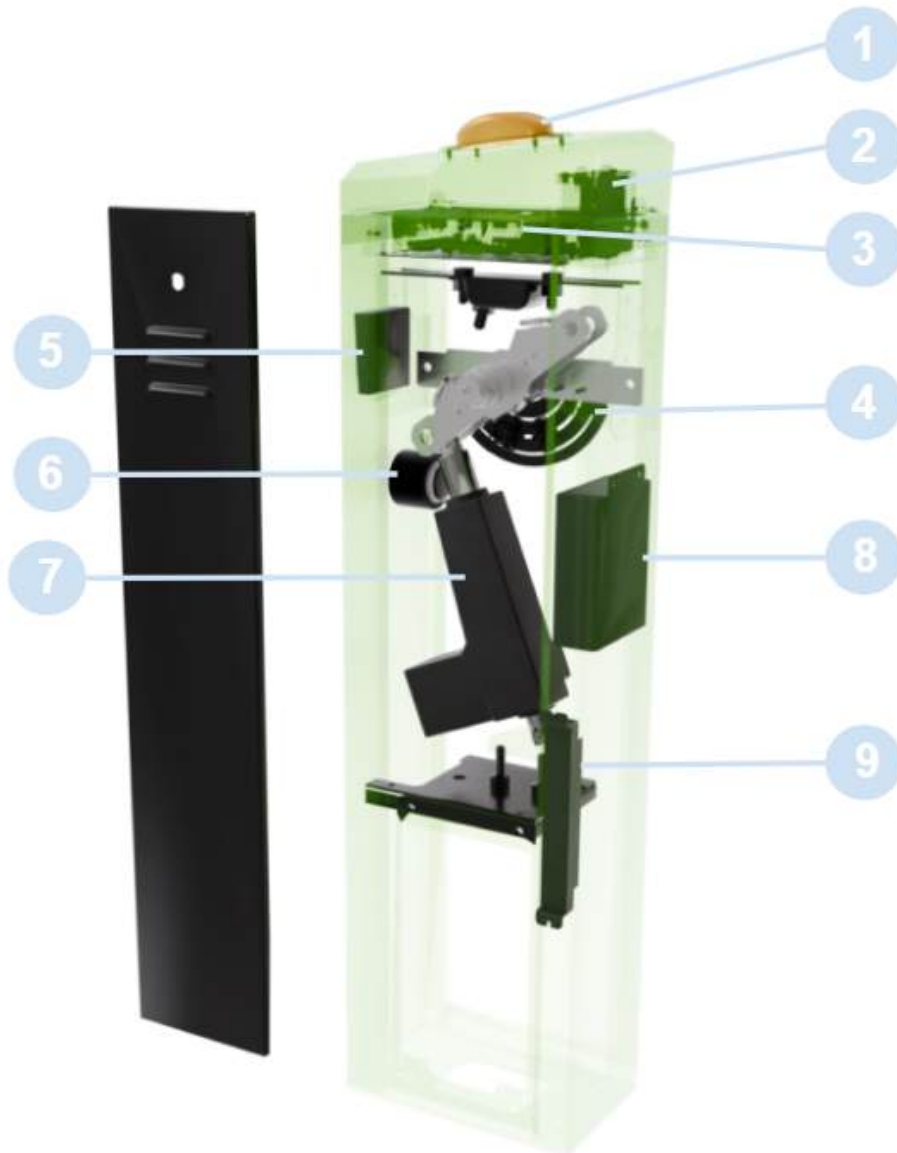
Рисунок 3. Внешний вид и состав шлагбаума
