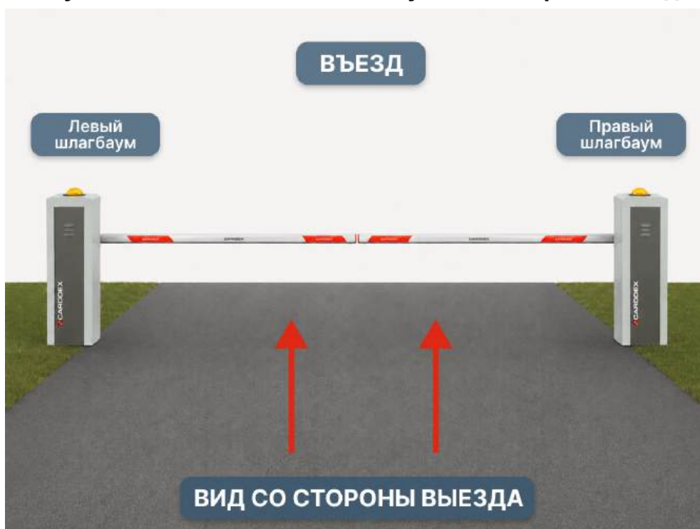
Рисунок 2. Расположение шлагбаумов со стороны выезда
