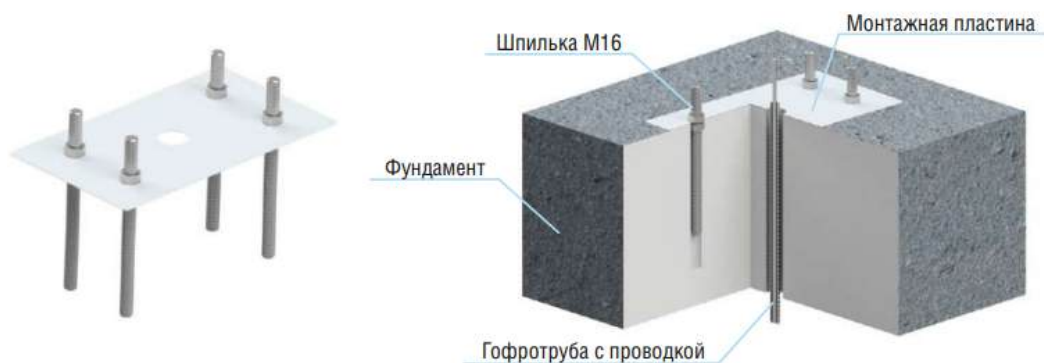
Рисунок 23. Устройство фундамента с монтажным комплектом.
