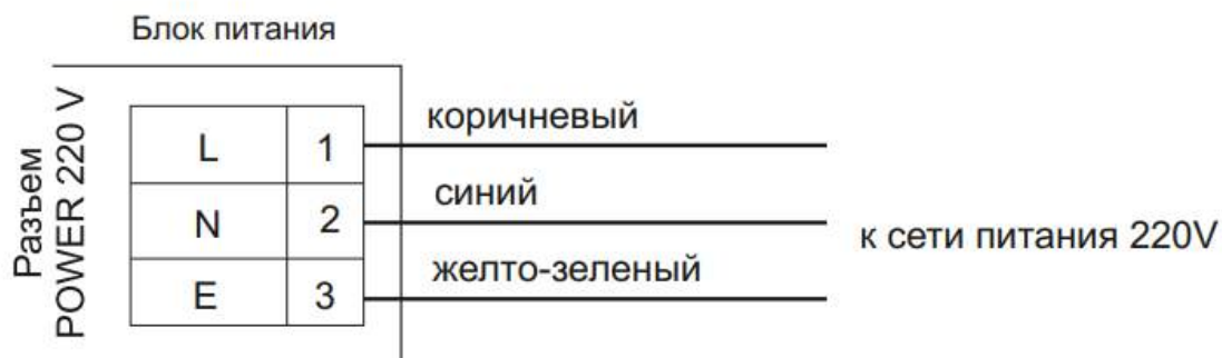
Рисунок 23. Схема подключения блока питания
