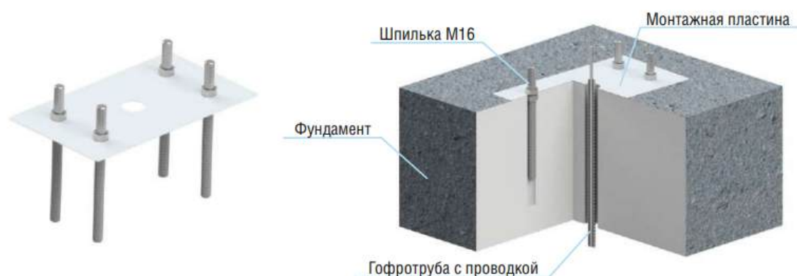
Рисунок 19. Устройство фундамента с монтажным комплектом.
