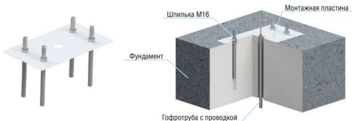
Рисунок 20. Устройство фундамента с монтажным комплектом.
