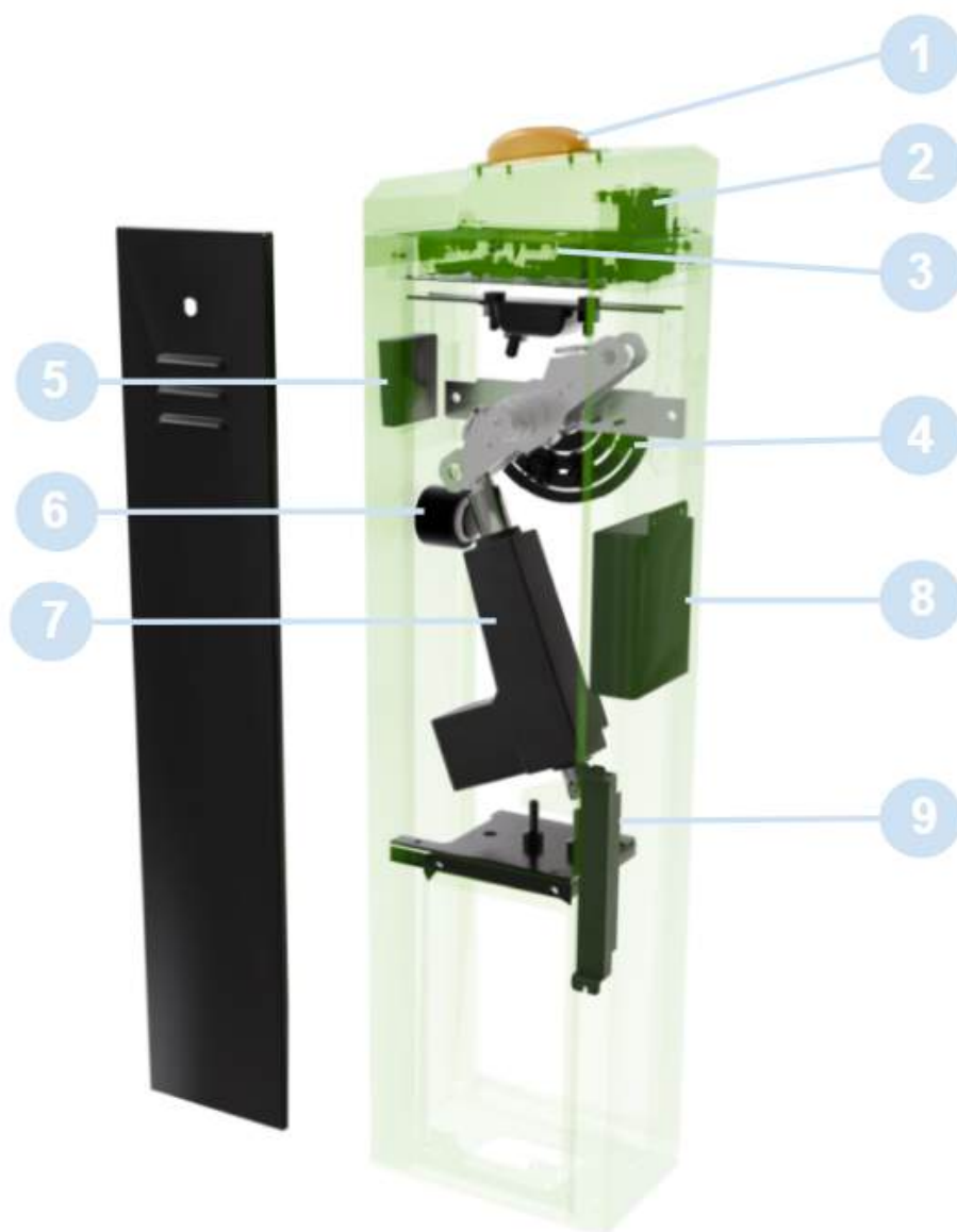
Рисунок 3. Внешний вид и состав шлагбаума
