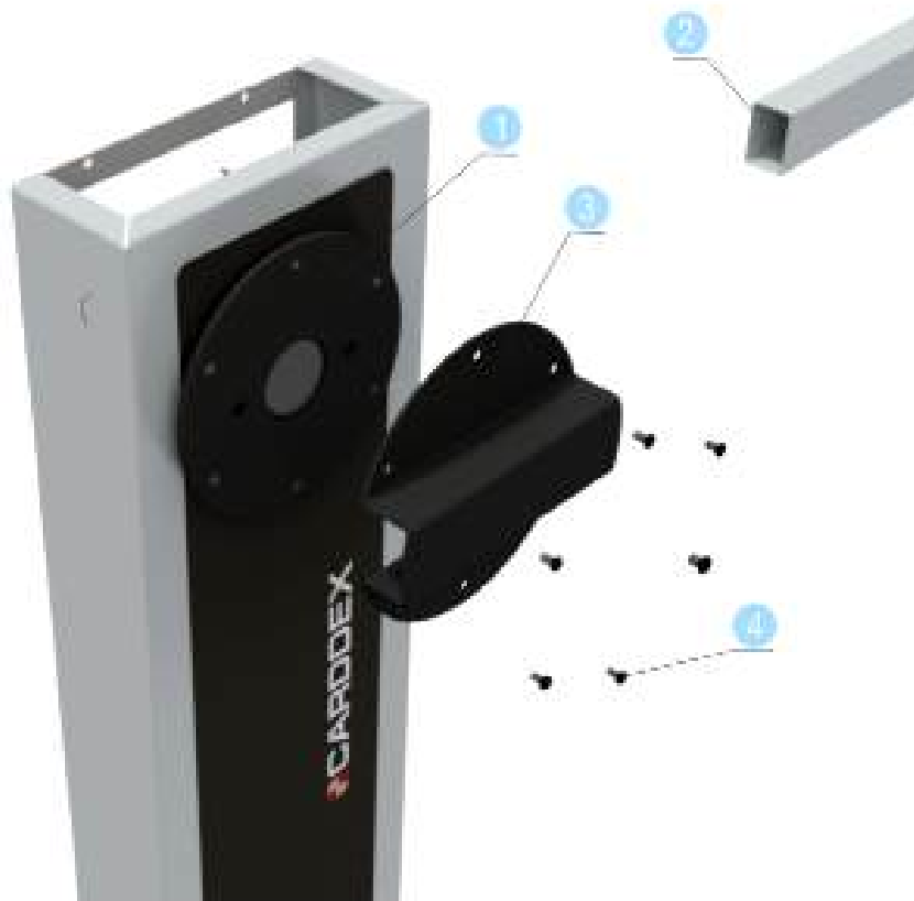
Рисунок 5.2 Устройство узла крепления стрелы
