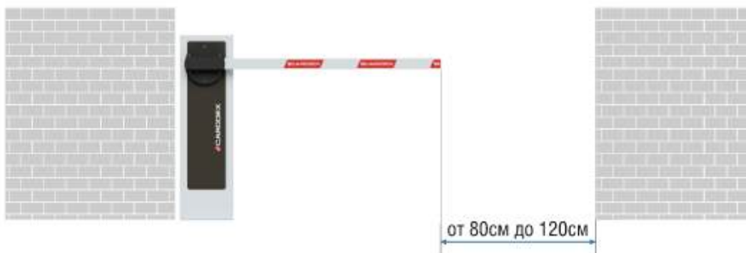
Установка шлагбаума с пешеходной зоной
