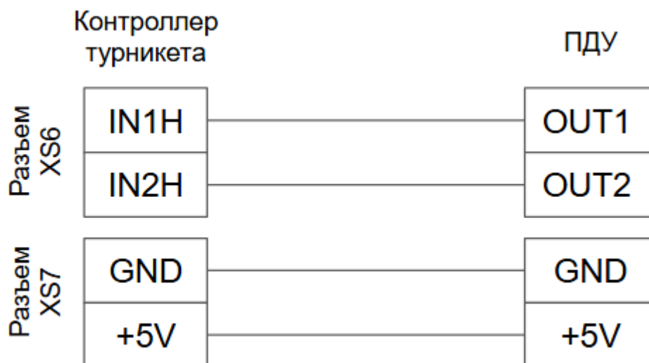
Рисунок 3. Схема подключения ПДУ TW-02
