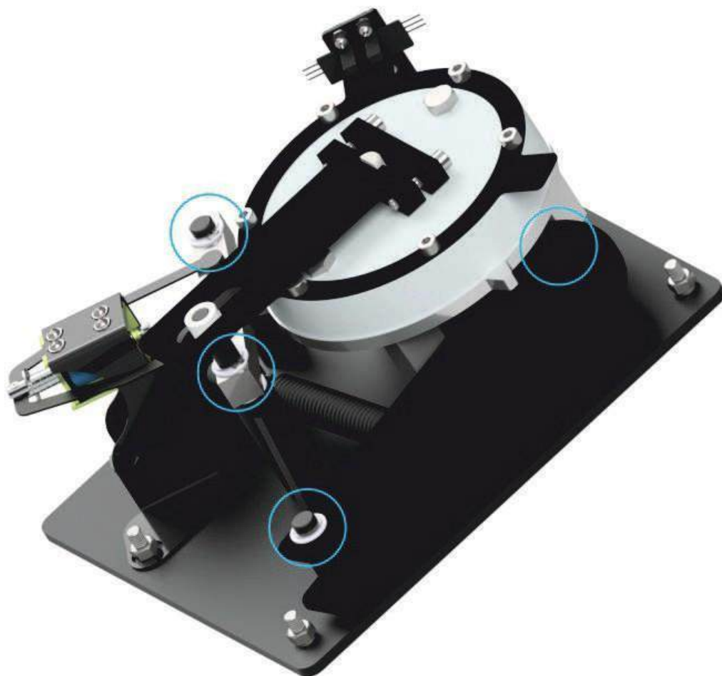
Рисунок 12.5.1 - Места смазки подвижных частей
