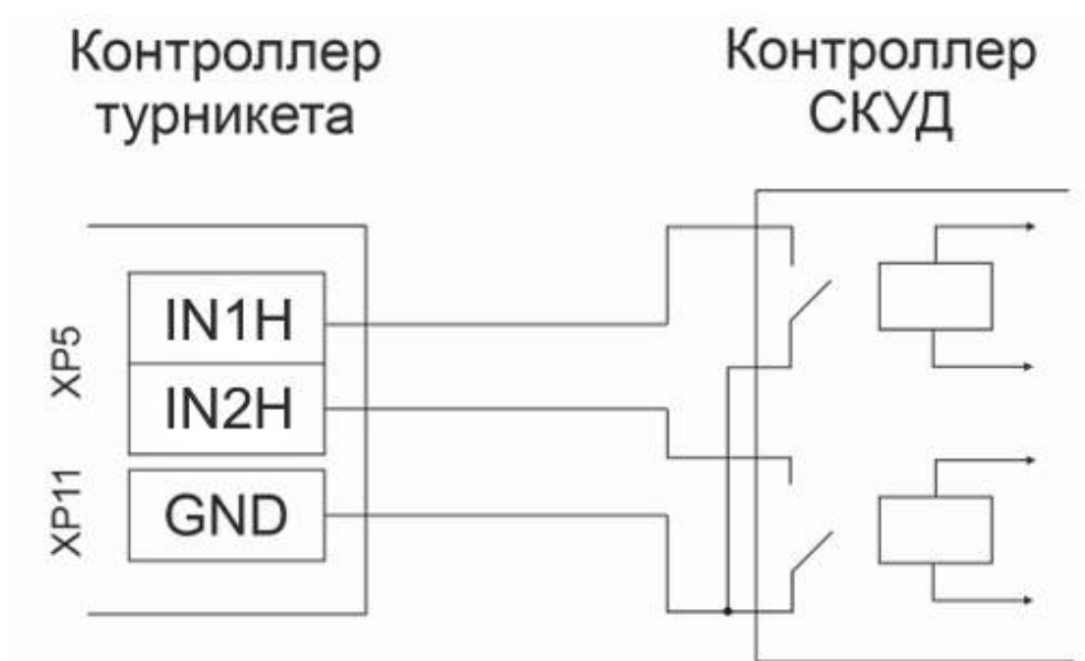
Рисунок 8.2.2 Схема подключения турникета к СКУД «сухой контакт»
