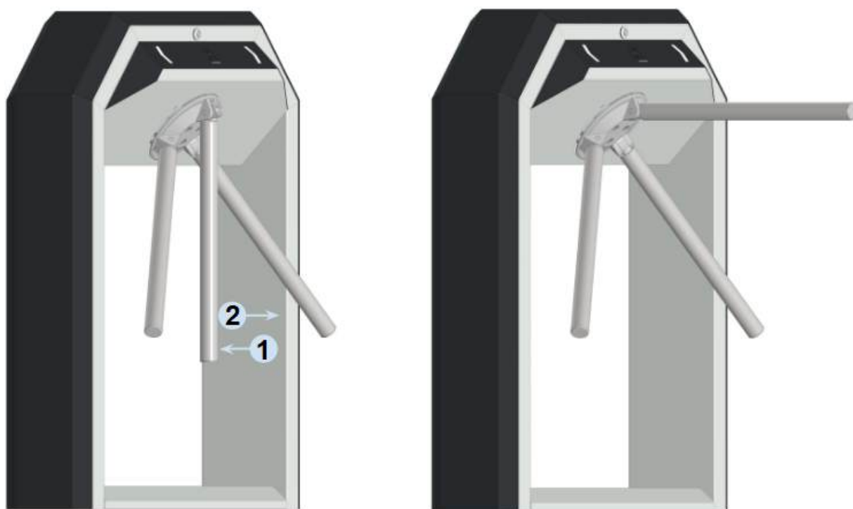
Рисунок 6.5.3 Установка планок в положение блокировки прохода
