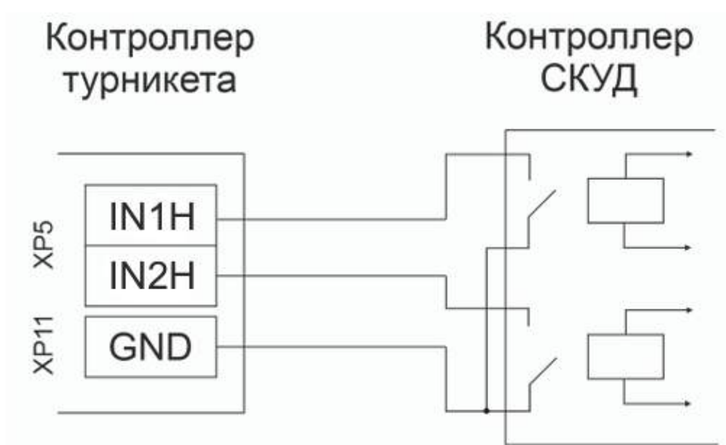
Рисунок 8.2.2 Схема подключения турникета к СКУД «сухой контакт»
